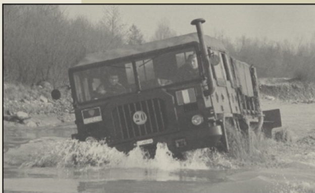
Hierboven 2x: 6606 CM, 6x6, 5 ton, artillerietrekker medium, dubbele cabine, 12 personen.
