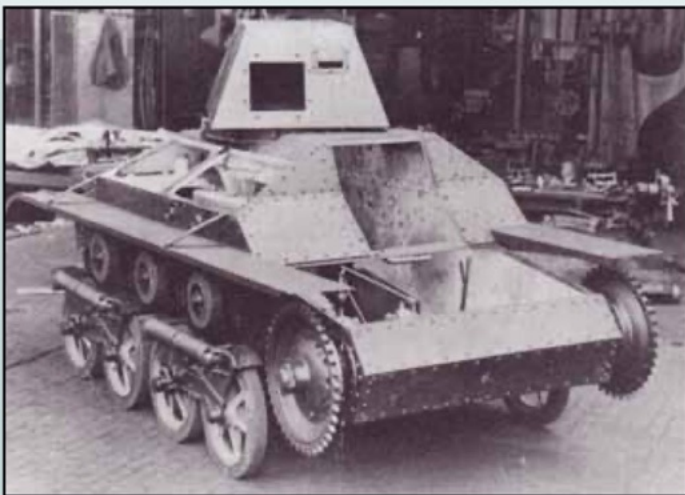
Lichte Tank Mark II in de fabriek in aanbouw. De motor en het Horstmann onderstel zijn al geïnstalleerd.
