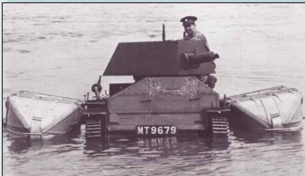
De drijvende Light Tank Mk.II. Opvallend zijn de opstaande uitlaat en het dichtgesmeerde bestuurdersluik. Een bemanningslid zit op zijn hurken op het achterdek om de buitenboordmotor te bedienen
