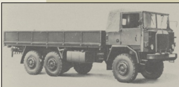
Hierboven 2x: 6606 CM, 6x6, 5 ton, artillerietrekker medium, dubbele cabine, 12 personen.
